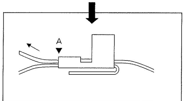
ペンチを用いて適当な力でバンドを引っ張った後、Aの部分で反対側に折り曲げて下さい。
