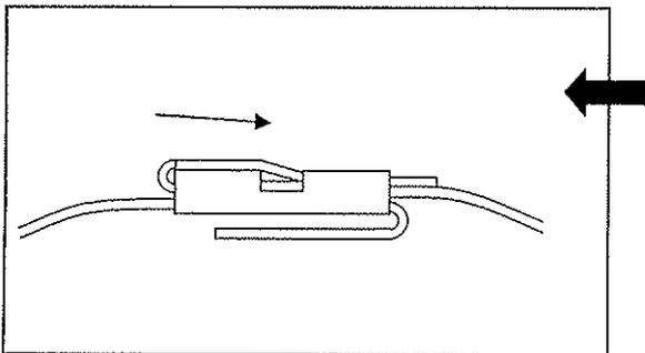
折り曲げたバンドが戻らない様にシールの爪(立っている部分)で押えれば完了です。
