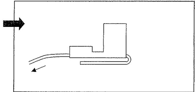
エントーバンドを必要な長さでカットしてシールに通し、通したバンドの先端を内側に折り曲げて抜けないようにセットして下さい。
