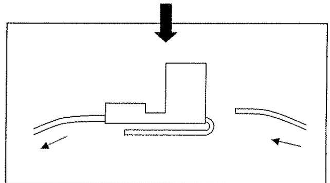
もう片方のバンドの先端を断熱材の外周に廻して、再度シールに差し込んで下さい。
